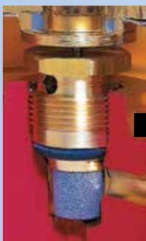
Gekapselter Ventilsitz mit Filter
