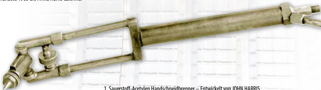
1. Sauerstoff-Acetylen Handschneidbrenner – Entwickelt von JOHN HARRIS.
