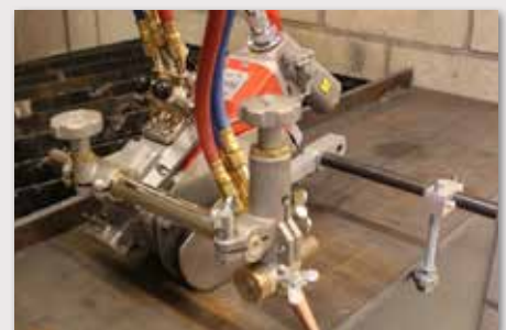
Faseschneiden von Blechkanten mit Kanten-Rollenführung
